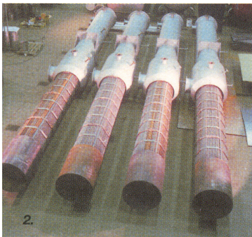
4 st skruvtubsvärmeväxlare för installation i ett värmeverk i Kina
