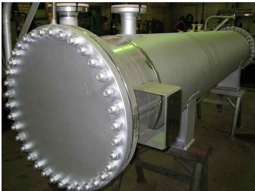
Skruvtubsvärmeväxlare för värmning av beckolja. Installerad i ett skogsföretag i mellersta Norrland 2008.
