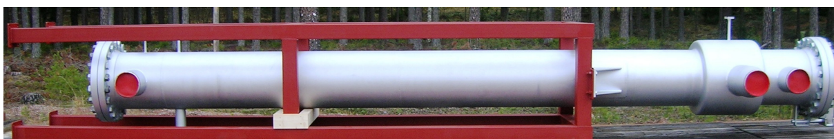
Ångkondensor med skrutuber levererad till ett värmeverk i södra Norrland 2010
